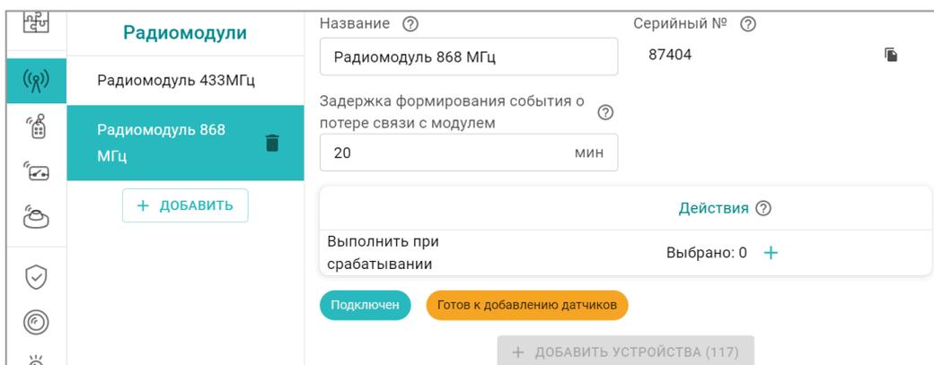
**Для регистрации датчиков 868 МГц** в период действия режима добавления радиоустройств нужно нажать и удерживать кнопку на плате датчика до того момента пока светодиодный
