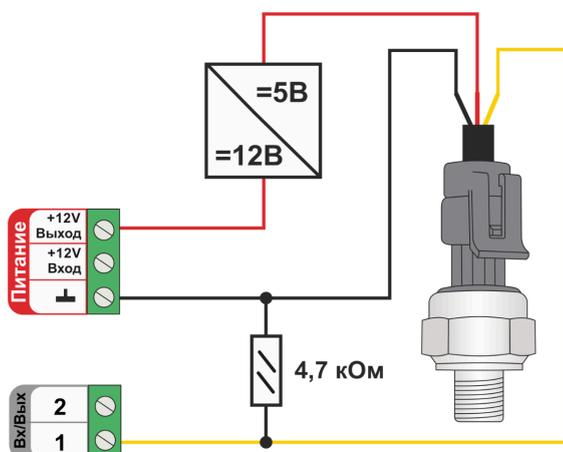
**Примечание:** Тип сенсора входа Контроллера, выбранного для контроля датчика давления должен быть указан как “аналоговый вход”, а единицы измерения “Бар”. Для пересчета напряжения на выходе датчика в давление и калибровки этих показаний необходимо заполнить таблицу
