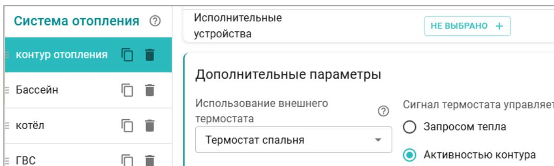
Контроллер, по сигналу от комнатного термостата, формирует “запрос на тепло” котловому контуру, равным значению *верхней границы температуры теплоносителя*, указанной в настройке отопительного контура и управляет работой исполнительных устройств, назначенных для регулирования температуры:
