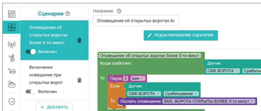
**ВНИМАНИЕ!!!** В сценарии **НЕЛЬЗЯ** использовать команды управления выходами Контроллера, назначенными для управления исполнительными устройствами отопительных контуров.
