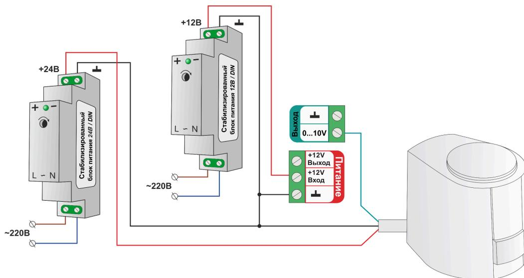
**ВНИМАНИЕ!!!** Некоторые приводы запитываются от источников питания переменного тока. В тех случаях когда привод имеет три вывода: два из которых – питание привода и третий управляющий, схема подключения такая же как и для приводов запитанных от источников постоянного напряжения.
