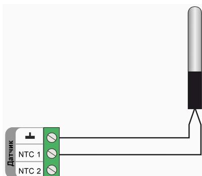
Схема подключения датчиков NTC-10 к универсальным входам/выходам Контроллера.
