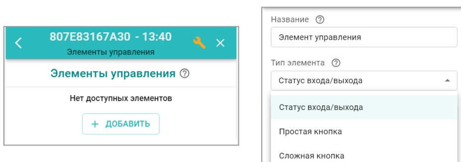
Элемент управления может быть “Статусом входа или выхода” и отображать текущее состояние универсального входа или релейного выхода Контроллера, или может быть “Простой” или “Сложной” кнопкой и управлять выходами Контроллера.
