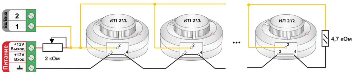
переменного резистора при текущем положении движка и заменить на резистор с постоянным сопротивлением или оставить переменный резистор в шкафу, закрепив его в пучке проводов.
