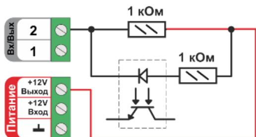
Особенность этой схемы заключается в том, что оптрон может включиться (загорится внутренний светодиод оптрона) даже от малого тока через цепь +3,3 В – 100 кОм – оптрон – +12 В. Чтобы этого не произошло, рекомендуем включить дополнительные резисторы номиналом 1 кОм.
