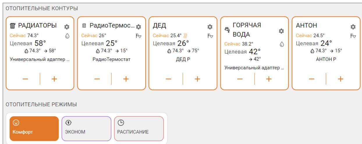
**Примечание:** Рекомендуется включать в каждый “Отопительный режим” все отопительные контуры из конфигурации Контроллера. В этом случае, переключая режимы, пользователь гарантированно изменит задание в каждом контуре. Если этого не сделать и не указать контур в режиме, то в таком контуре сохранится прежнее задание.
