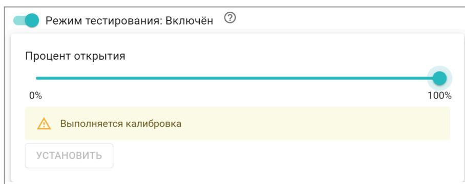
**ВНИМАНИЕ!!!** Используйте “Режим тестирования” только при пусконаладочных работах. После применения режима тестирования Контроллер необходимо перезапустить по питанию.
