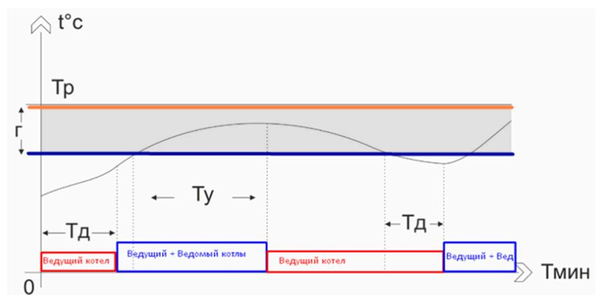
По запросу на тепло от любого из отопительных контуров, стартует ведущий котел и одновременно с этим начинается отсчет **T<sub>d</sub>** времени задержки на включение ведомого котла.
