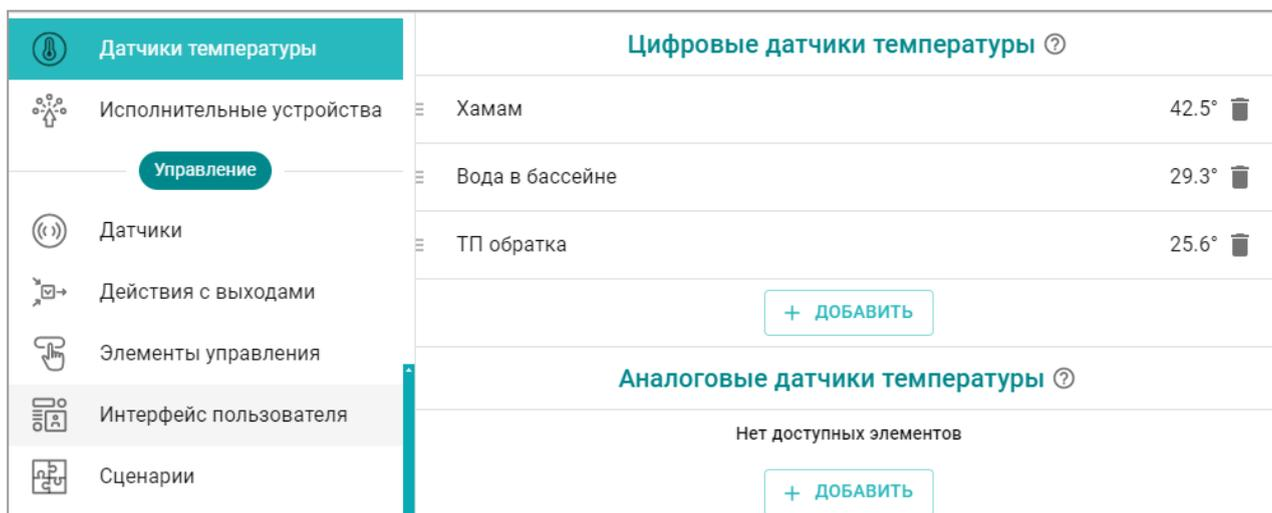
**ВНИМАНИЕ!!!** При подключении к Контроллеру аналоговый датчик температуры автоматически не определяется и не отображается в конфигурации Контроллера. Его необходимо добавить вручную в разделе настроек “Аналоговые датчики температуры”, указать номер Входа (NTC или универсального), к которому датчик физически подключен, тип подключаемого датчика и сопротивление резистора подтяжки, если датчик подключен к универсальному входу/выходу, а не к входу NTC.
