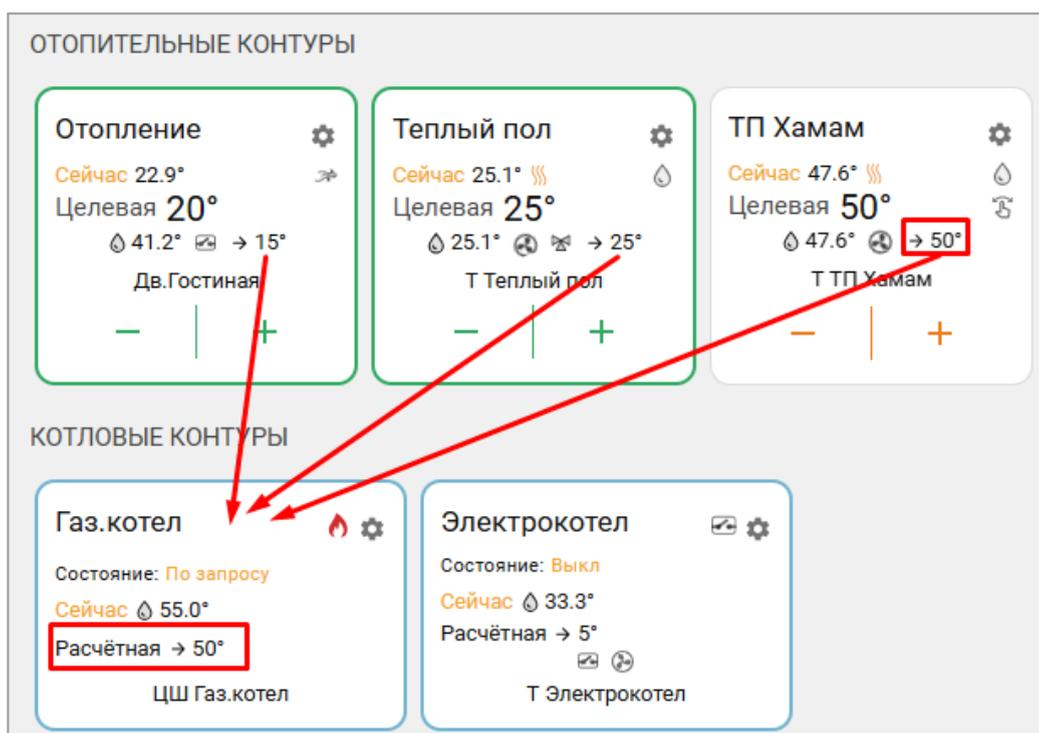
Котловой контур обрабатывает “запросы на тепло” от Отопительных контуров и контура ГВС. Он определяет от какого контура запрашивается температура теплоносителя *большее* значения и именно это значение передает в цифровую шину котла как расчетную температуру нагрева теплоносителя.
