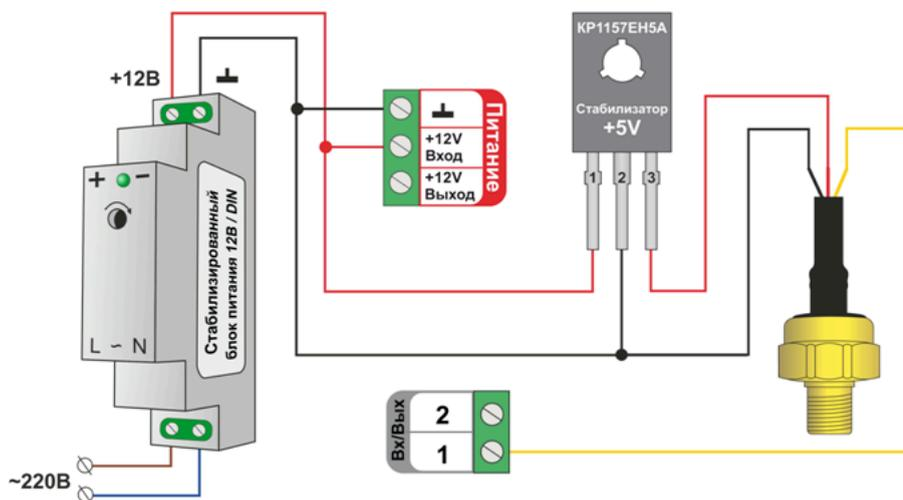
Вместо стабилизатора KP1157EH5A можно использовать любой аналогичный стабилизатор напряжения +5В в корпусах TO-126 или TO-92.
