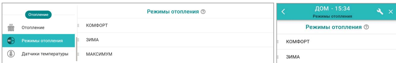
В Режим отопления включаются отопительные контуры (Потребителя и ГВС), где каждому задается целевая температура или вариант работы. Контур может не входить в состав некоторых режимов. В этом случае при включении режима, где контур не указан, сохраняется ранее заданный ему вариант работы (целевая температура).
