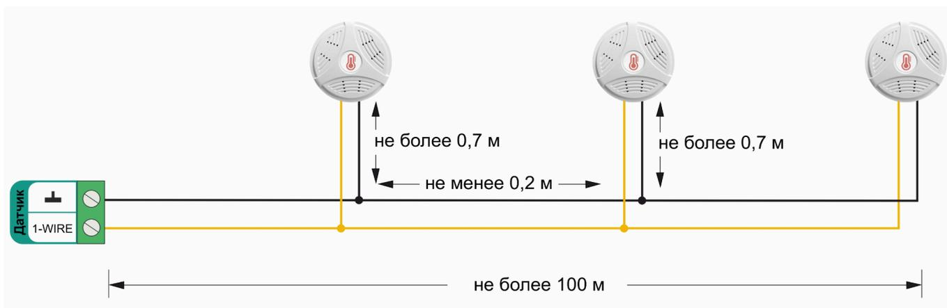
Подключение датчиков по трехпроводной схеме:
