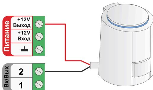
Схема подключения к релейному выходу:
