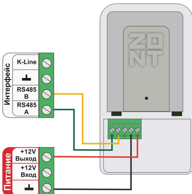
Схема подключения радиомодуля по **K-Line:**
