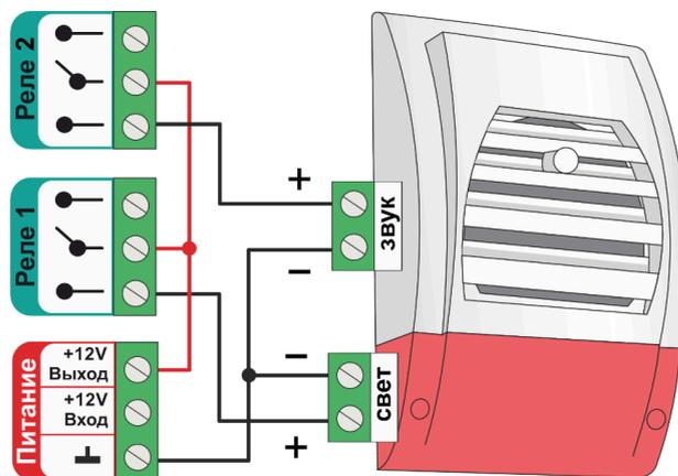
**Примечание:** В неактивном состоянии выхода ОК из-за утечки тока при подключении нагрузки с высоким сопротивлением, у некоторых типов светозвуковых оповещателей (например МАРС-12 КП), может наблюдаться слабое свечение светодиода и треск или писк динамика. Для исключения такого эффекта рекомендуется подключать оповещатели через промежуточное реле.
