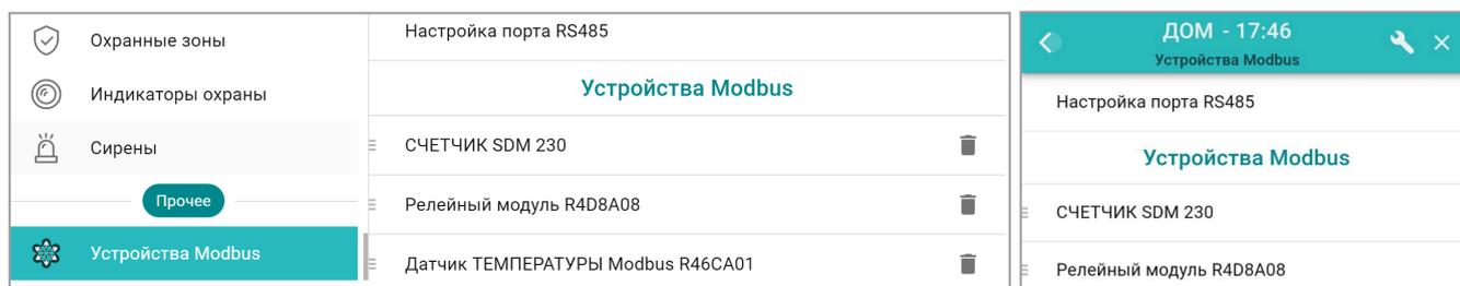
Включение режима Modbus автоматически исключает возможность использования в конфигурации Контроллера оригинальных цифровых устройств ZONT подключенных к шинам RS-485 и K-Line.
