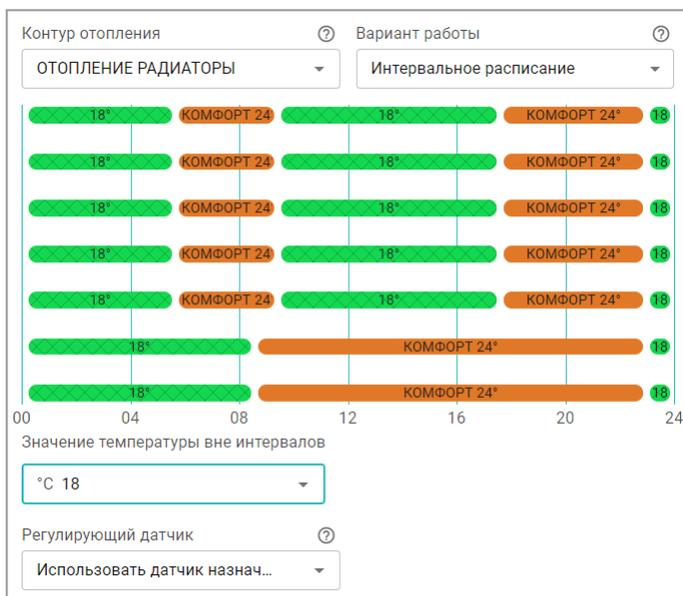
Целевая температура или целевой режим отопления в интервальном расписании задаются с шагом не менее одной минуты. Доступно создание нескольких временных интервалов. Вне созданных интервалов задается или общий режим отопления или целевая температура, которые будут выполняться Контроллером.
