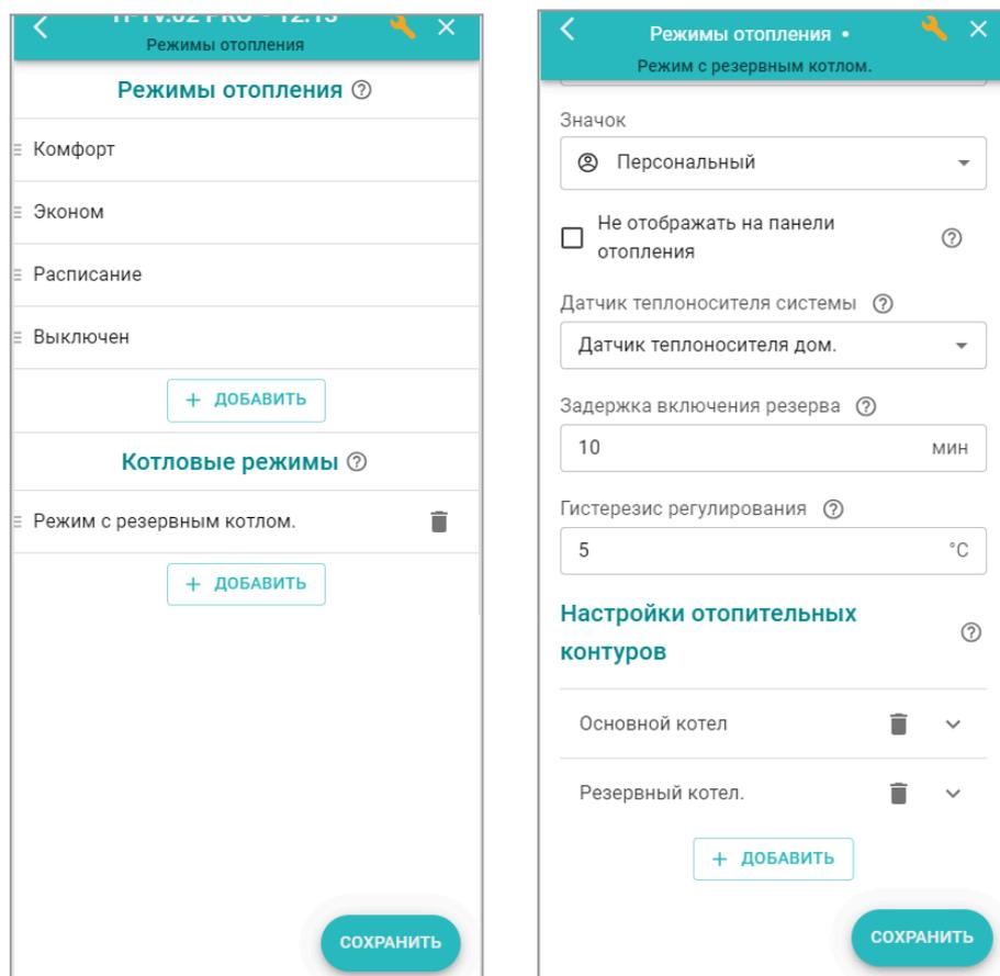
Для этого отслеживается текущая температура подачи в систему отопления (обычно по датчику гидрострелки) и при ее снижении более величины заданного гистерезиса формируется команда запуска резервного котла.
