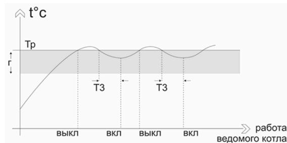
Алгоритм каскада формирует расчетную температуру по фактическому запросу на тепло от отопительных контуров имеющему большее значение и, при условии что она попадает в зону гистерезиса, поддерживает ее с точностью +/- 3 градуса.
