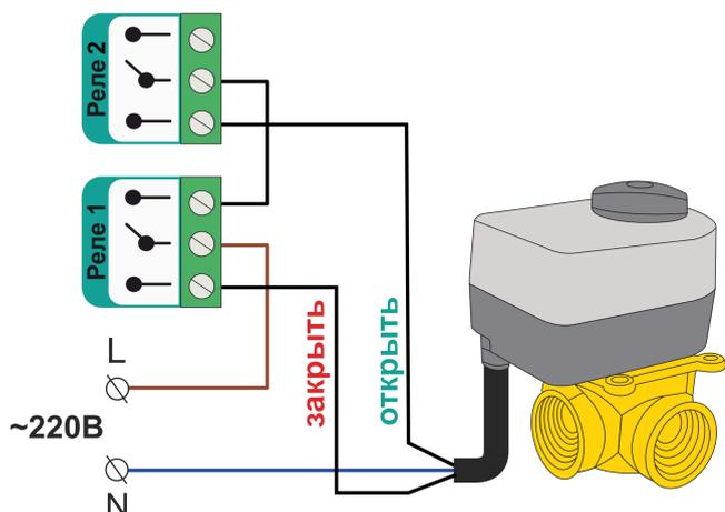
Схема подключения электропривода к выходам ОК через промежуточные реле с защитой от одновременной подачи напряжения на вывод “открыть” и на вывод “закреть” привода:
