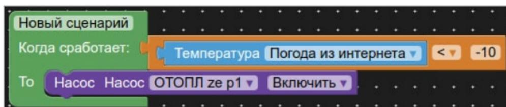
*Пример:* Надо включить насос, когда температура на улице опустится ниже -10°C. Сценарий контролирует показания уличной температуры и при ее снижении до значения -10,1°C насос включается и работает до тех пор, пока не будет выключен пользователем, т.к. в сценарии нет другого условия.
