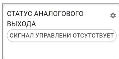
**Примечание:** Статус аналогового выхода будет активен только пока контроллер дает команду приводу на движение. В ручном режиме статус привода будет всегда в пассивном состоянии, т.к. ручная команда мгновенно изменяет состояние выхода с текущего на то, которое выставлено вручную.
