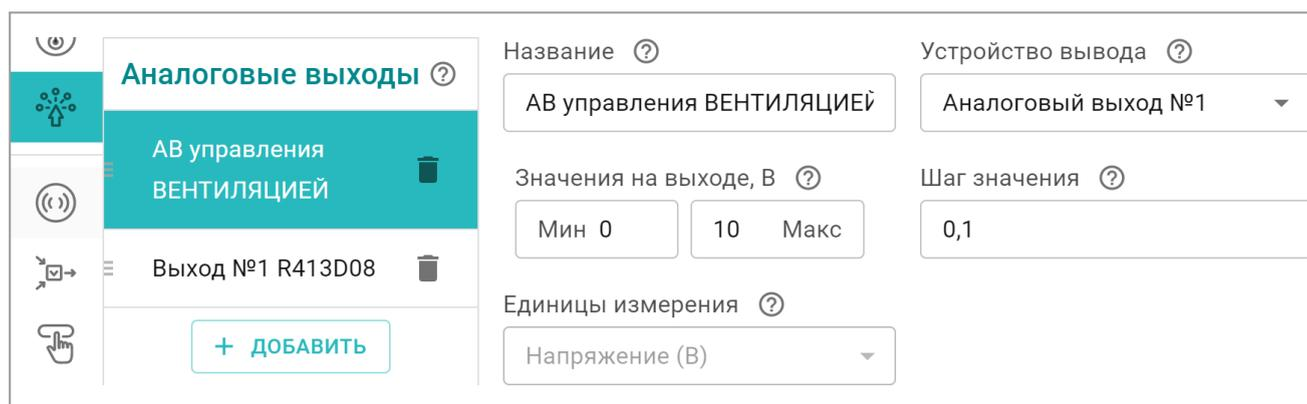
Параметр **Шаг значения** – это точность, с которой будет изменяться напряжение на аналоговом выходе. Шаг по сути определяет скорость изменения напряжения на выходе и, как следствие, чувствительность и точность управления исполнительным устройством подключенным к аналоговому выходу. Рекомендуемое значение 0,1 В.
