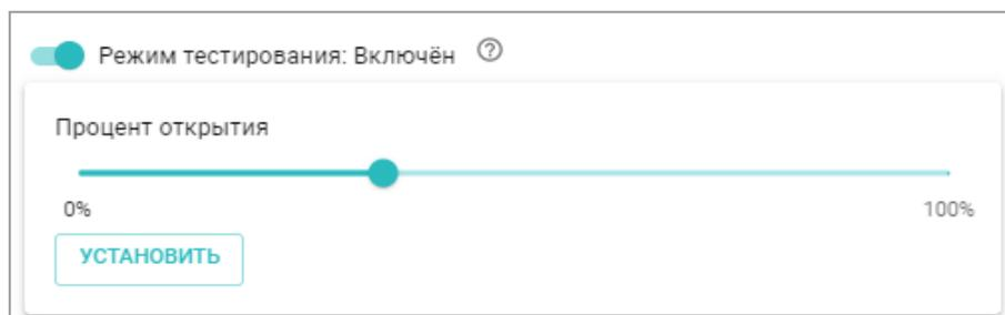
Отображение изменения управляющего напряжения на аналоговом выходе доступно на графике, в котором выбран параметр **Элемент управления: состояние**, как в режиме тестирования,
