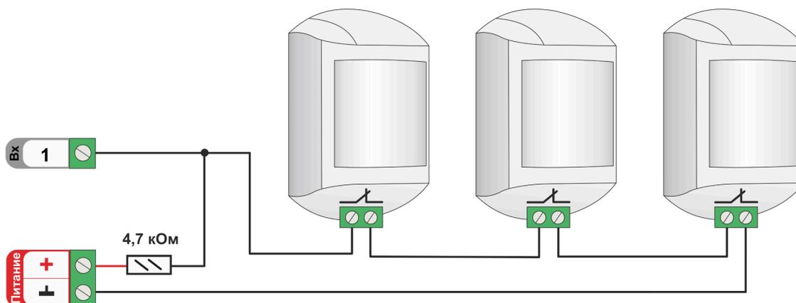
Так как **напряжение питания** на контроллере “+12 В”, то для расчета пороговых значений контролируемого напряжения на шлейфе ИК датчиков и определения факта срабатывания используются следующие формулы:
