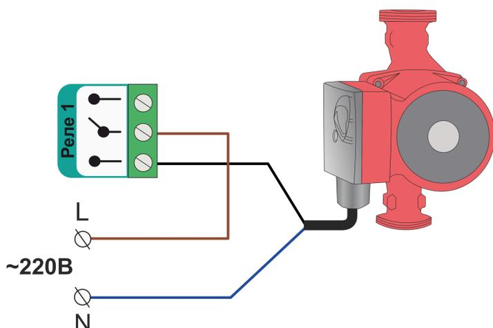
**Насосы с напряжением питания +24 Вольта и выше**, к выходам ОК подключаются только через дополнительное промежуточное реле (в комплект не входит). Характеристики контактной группы реле должны соответствовать подключаемой нагрузке, а управляющая обмотка промежуточного реле - напряжению питания контроллера.
