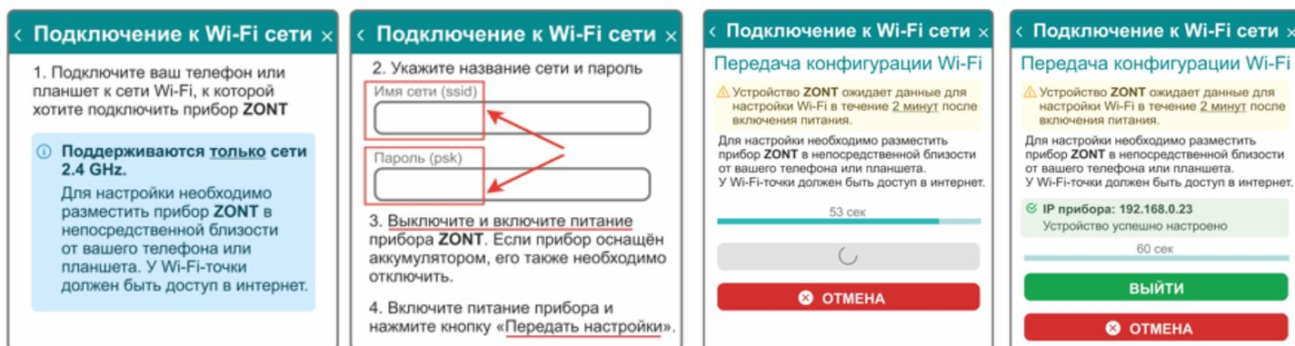
**ВНИМАНИЕ:** Смартфон с приложением ZONT нужно подключить к той же сети Wi-Fi, в которой будет работать Контроллер. Роутер должен быть настроен на работу в диапазоне 2,4 ГГц и раздавать интернет в режиме "router" (режимы "мост"/"bridge" непригодны).
