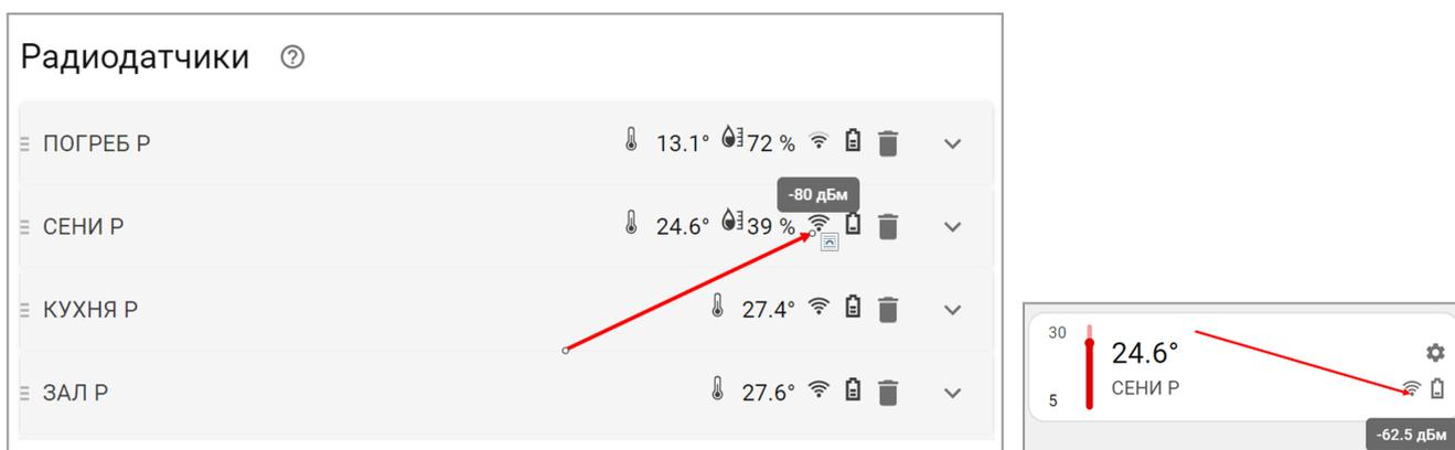
**ВНИМАНИЕ!!!** Если мощность радиосигнала датчика менее -90ДБм, то обмен данными с ним не стабильный, и Контроллер будет периодически информировать о потере связи с радиоустройством. В этом случае необходимо найти другое место для размещения радиодатчика и/или радиомодуля.
