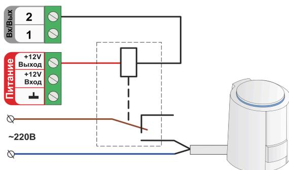
В качестве дополнительного промежуточного реле рекомендуется использовать **реле 12V DC артикул ML0000291**. Ссылка на карточку товара ресурс Zont-online.ru [Реле промежуточное на DIN-рейку, 12V DC в сборе](#).
