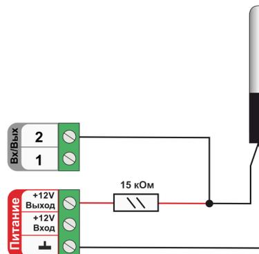
Для подключения датчиков NTC-10 к универсальным входам/выходам необходимо использовать подтягивающий резистор 15 кОм с точностью 1%, подключенный между входом и клеммой питания "+12 В".
