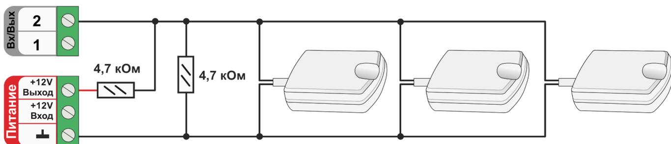
**ВНИМАНИЕ!!!** При подключении датчика протечки Астра 361 надо соблюдать полярность. При неправильной полярности подключения датчик всегда показывает сработку.
