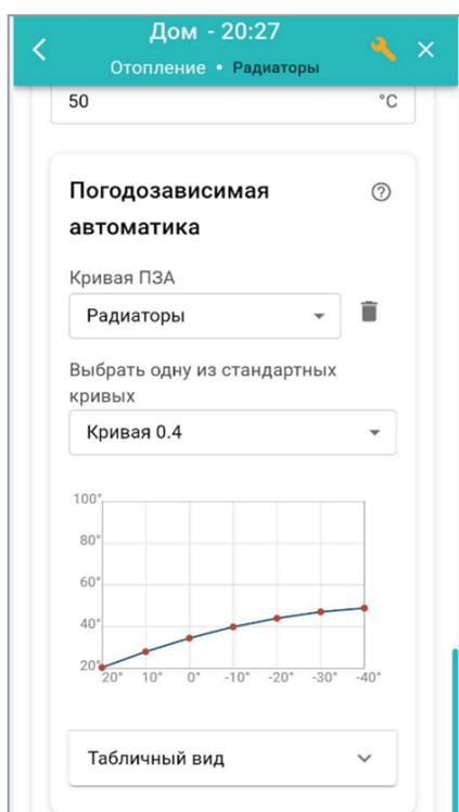
График для кривой ПЗА строится с помощью выделения точки двойным кликом и перетягивании ее относительно осей координат в желаемое место.
