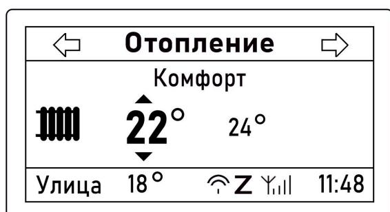
**Примечание:** В контуре “Котел” изменить целевую температуру нельзя, т.к. это значение определяется автоматически по запросу тепла от контуров потребителя и ГВС.
