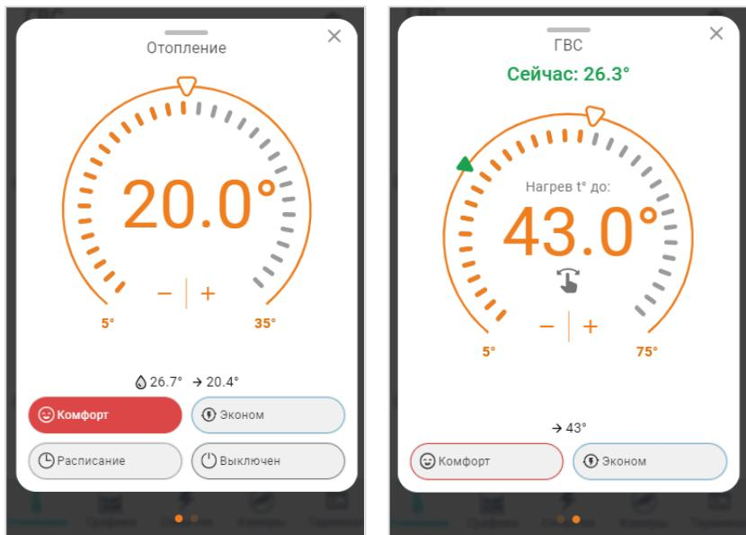
Цвет рамки карточки контура Отопление и контура ГВС совпадает с цветом действующего режима отопления. При изменении целевой температуры в ручном режиме, рамка карточки контура бесцветная.
