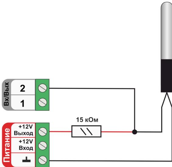
В схеме подключения такого датчика обязательно применяется подтягивающий резистор (15 кОм, 1%).
