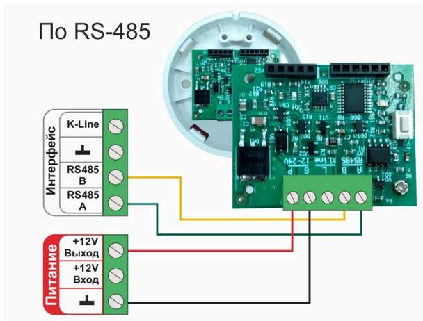
Подключение схемы подключения нескольких датчиков:
