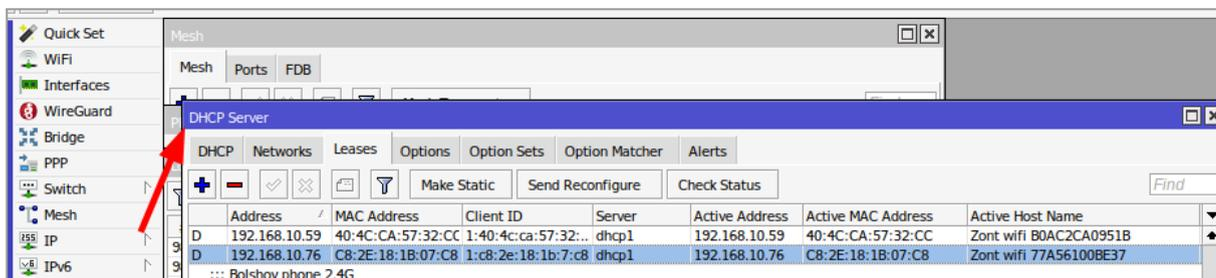
2. Укажите в браузере IP-адрес для подключения. При таком способе подключения контроллер будет доступен по точному адресу или универсальному: **zont.local**.
