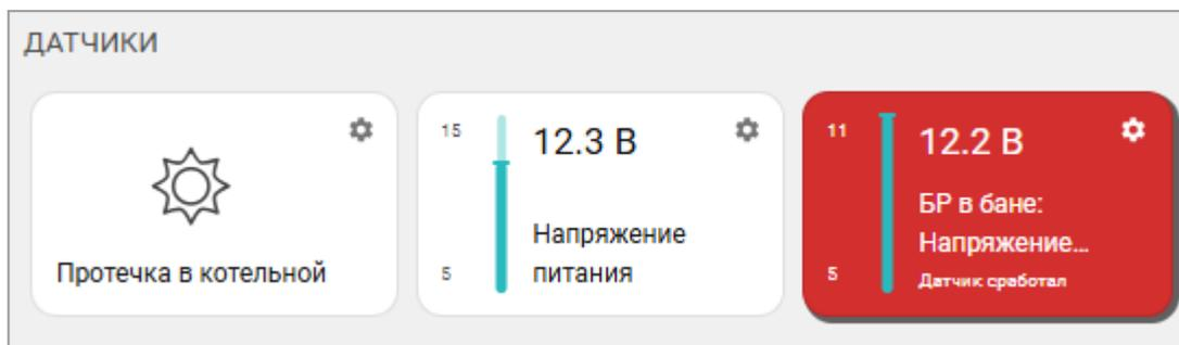
Клик по карточке датчика вызывает справку с его текущим состоянием и графиком. При отклонении показаний датчика за пороговые значения или его сработке карточка датчика окрашивается в заданный ему при настройке конфигурации цвет: По умолчанию – красный (цвет аварии). Возможен выбор желтого цвета (предупреждение), зеленого (норма) и синего (нейтральный). При выходе измеряемого датчиком параметра за пороговые значения цветом выделяется порог, за который вышел измеряемый параметр.
