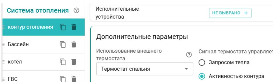
Контур в этом случае формирует “запрос на тепло” равным значению *верхней границы температуры теплоносителя*, указанной его настройкой и управляет работой исполнительных устройств контура, с целью поддержания заданной цели:
