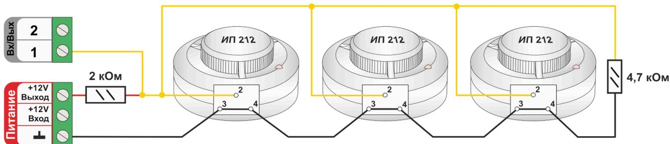
Для правильной работы датчиков требуется установка дополнительных резисторов:
