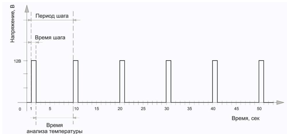
**Период шага** для управления трехходовым краном настраивается в пределах от 10 до 600 секунд. Для управления двухходовым краном (термоэлектрическим клапаном) он всегда равен 10 сек. и не может быть изменен настройкой)
