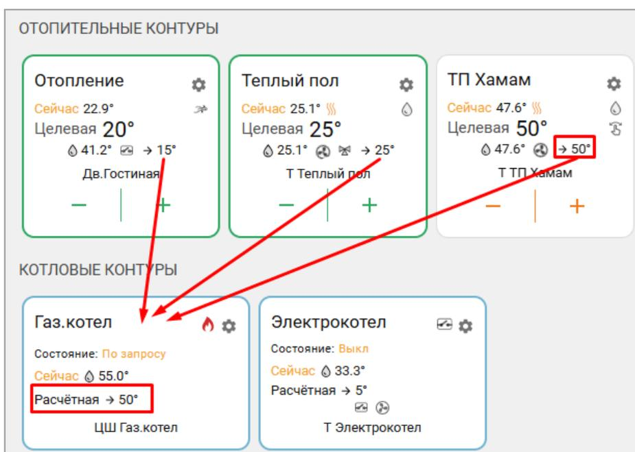
Параметр “запрос на тепло” задается только в тех Отопительных контурах, где для поддержания цели регулирования есть необходимость повышать температуру на подаче котла. Если такой необходимости нет (в системе используется теплоаккумулятор или котел работает на гидрострелку по ПЗА), то “запрос на тепло” в отопительном контуре лучше не использовать.
