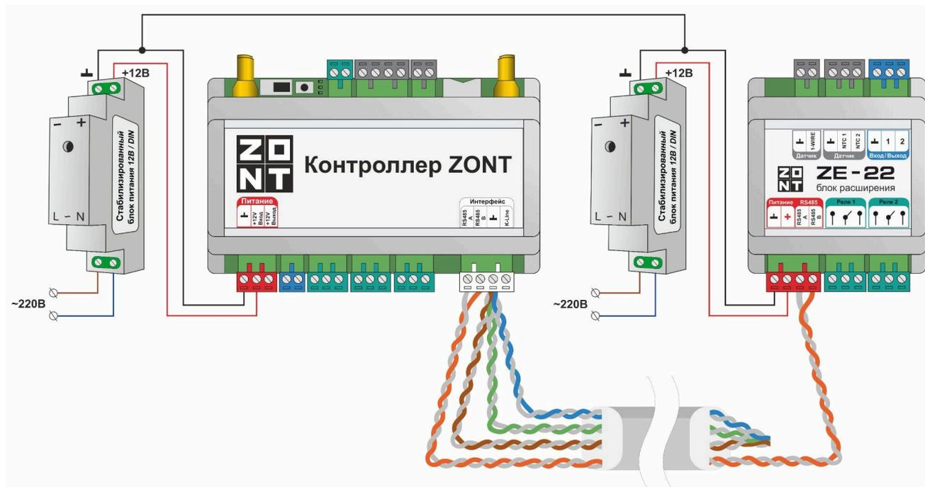
**Примечание:** Максимальная длина линии связи интерфейса RS-485 – 200 метров. При необходимости линии связи большей длины требуется установка дополнительных резисторов 120 Ом между каналами А и В шины с обеих сторон линии связи.
