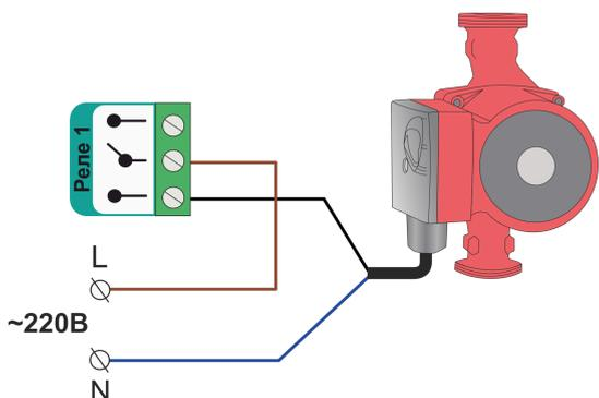
Схема подключения насоса к универсальному выходу (OK):
