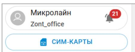
Предупреждения об аварии и других важных событий по всем устройствам, зарегистрированным в аккаунте, отображаются пока не будет устранена авария или прочитаны. При этом рядом с названием аварийного прибора отображается символ аварии
