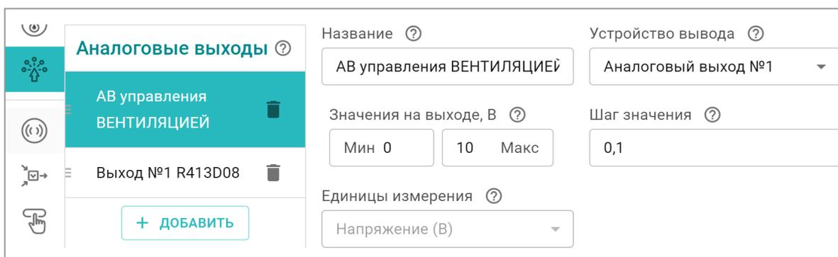
Параметр **Шаг значения** – это точность, с которой будет изменяться напряжение на аналоговом выходе. Шаг по сути определяет скорость изменения напряжения на выходе и, как следствие, чувствительность и точность управления исполнительным устройством подключенным к аналоговому выходу. Рекомендуемое значение 0,1 В.
