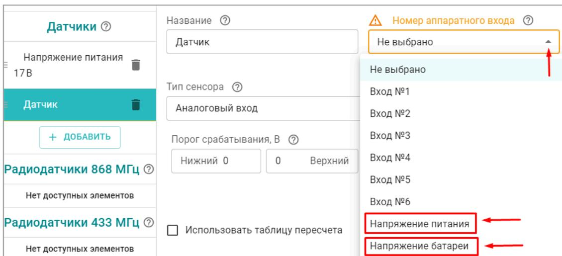
Чтобы при пропадании и восстановлении напряжения питания формировались оповещения и выполнялись действия необходимо задать нижний и верхний пороги контролируемого основного и резервного напряжения.
