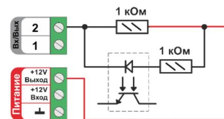
При этом учитывайте, что в схеме универсального входа/выхода прибора есть внутренний резистор подтяжки к цепи +3,3 В, номиналом 100 КОм. Особенность заключается в том, что оптореле может включиться (загорится внутренний светодиод оптрона) даже от малого тока через цепь +3,3 В - 100 КОм - оптрон - +12 В. Чтобы этого не произошло, включите в схему дополнительные резисторы номиналом 1 КОм.
