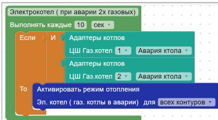
Решение: Использовать блок запуска “циклический контроль” с контролем состояния “аварии” у котлов каскада. Создать в конфигурации Контроллера *Котловой режим*, где каскад выключен, а электродкотел включается по запросу. (см. п.14.1 настоящей документации)
