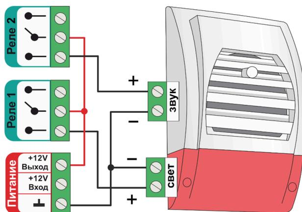
**Примечание:** Если при подключении к выходу ОК светозвукового оповещателя у него наблюдается слабое свечение светодиода и треск динамика, выполняете подключение через дополнительное промежуточное реле.
