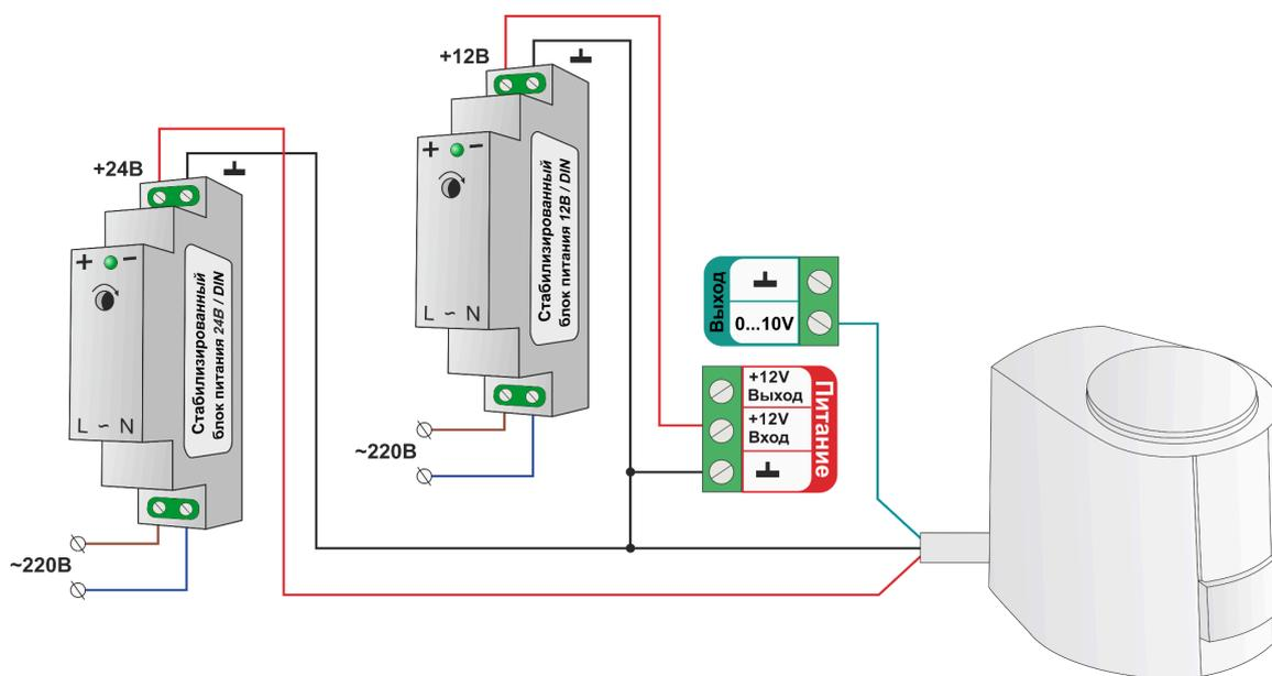
**Примечание:** Если питающее напряжение привода от источника переменного тока, ко входу контроллера привод подключается только сигнальным проводом. Схема подключения при этом аналогична приведенной выше.
