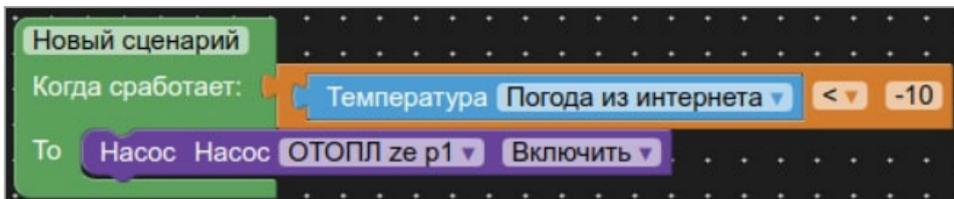
*Пример:* Надо включить насос, когда температура на улице опустится ниже  $-10^{\circ}\text{C}$ . Сценарий контролирует показания уличной температуры и при ее снижении до значения  $-10,1^{\circ}\text{C}$  насос включается и работает до тех пор, пока не будет выключен пользователем, т.к. в сценарии нет другого условия.
