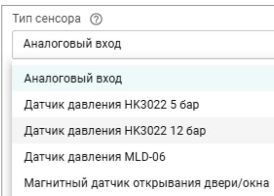
Если ни один из предустановленных заводской конфигурацией контроллера сенсоров не подходит для подключаемого датчика или необходимо контролировать изменение напряжения на входе - используйте сенсор “**Аналоговый вход.**”
