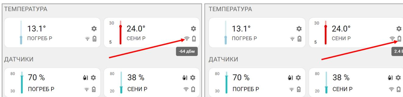
**Примечание:** Радиодатчики двойного назначения, такие как датчики температуры воздуха и влажности отображают измеряемые данные на разных карточках: температура воздуха
