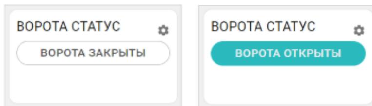
**“Простая кнопка”** или **“Сложная кнопка”** – Кнопка предназначена для передачи команды управления выходом и отображения его фактического состояния.
