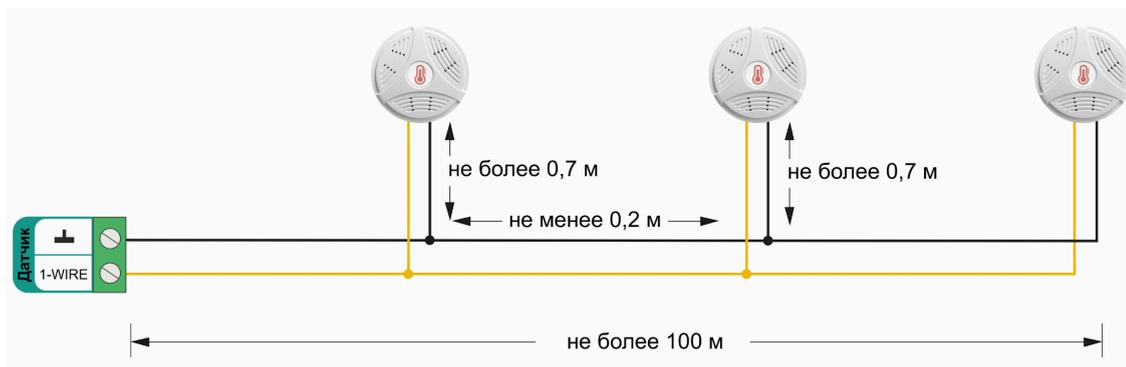
Подключение датчиков по трехпроводной схеме:
