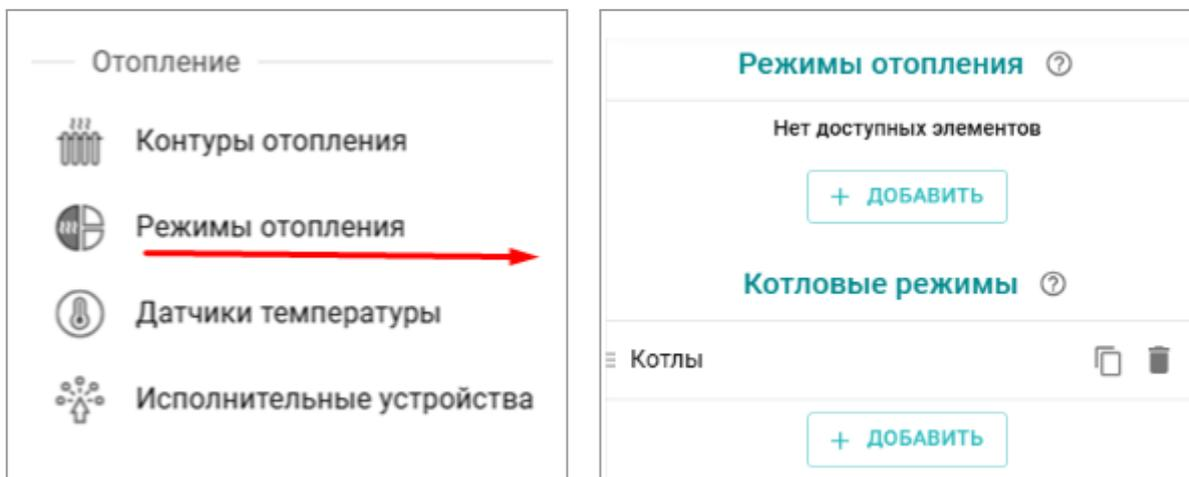
В каждый режим рекомендуется включить все контуры из созданной конфигурации. Каждому контуру в режиме задается цель: температура или вариант работы.
