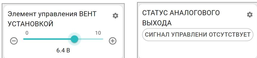
**Примечание:** Статус аналогового выхода будет активен только пока контроллер дает команду приводу на движение. В ручном режиме статус привода будет всегда в пассивном состоянии, т.к. ручная команда мгновенно изменяет состояние выхода с текущего на то, которое выставлено вручную. В режиме тестирования доступно изменение напряжения на аналоговом выходе для проверки правильности подключения и проверки направления движения исполнительного устройства.
