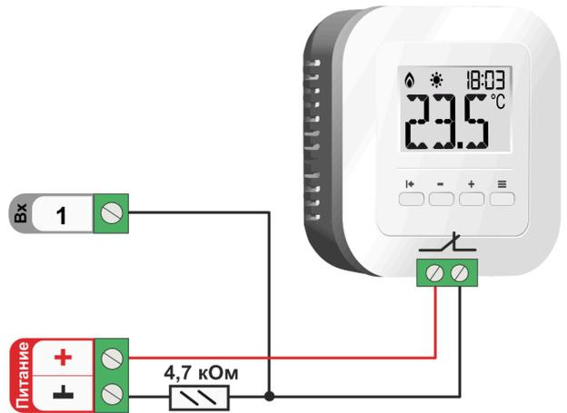
Так как **напряжение питания** на контроллере **“+12 В”**, то для расчета пороговых значений контролируемого напряжения на выходе комнатного термостата используется формулы:
