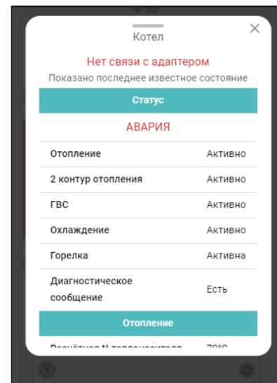
В данных диагностики параметров котлового контура отображается код аварии (ошибки). Кодировка ошибки имеет тот формат, в каком она присутствует в цифровой шине.
