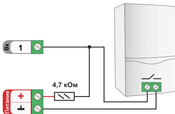
**ВНИМАНИЕ!!!** Проверьте напряжение на контактах котла. Если сигналу аварии соответствует напряжение 220В, при подключении ко входу Контроллера используйте дополнительное реле.
