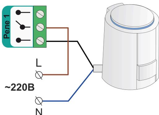
Электропривод двухходового смесительного клапана с напряжением питания 220 В подключайте к релейному выходу Контроллера.
