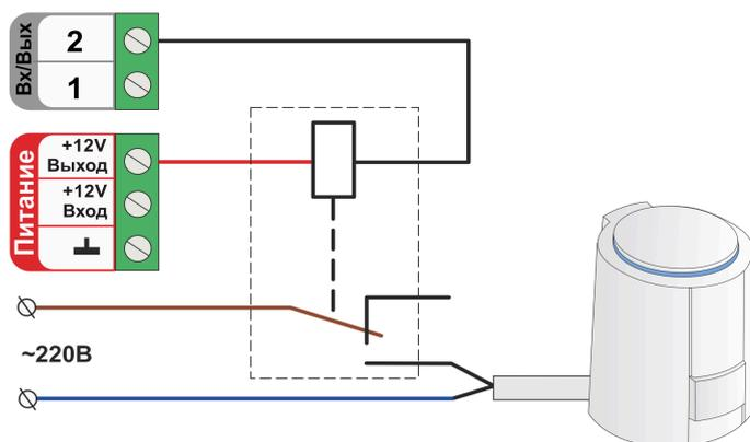
Электропривод двухходового смесительного клапана с **напряжением питания +24 В и выше** подключайте к выходам (ОК) только через дополнительное промежуточное реле с управляющей обмоткой +12В. При подборе реле учитывайте, что номинальные напряжение и ток должны соответствовать подключаемой нагрузке.
