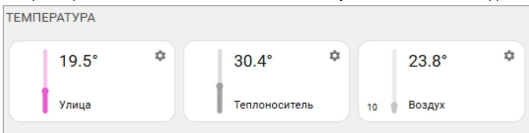
Клик по карточке датчика вызывает справку с его текущими параметрами и графиком. При отклонении температуры за пороговые значения, иконка датчика окрашивается в красный цвет и отображается порог, за который вышла фактическая температура. При отсутствии данных от датчика по которому производится регулирование в контуре, вместо значения отображается прочерки.
