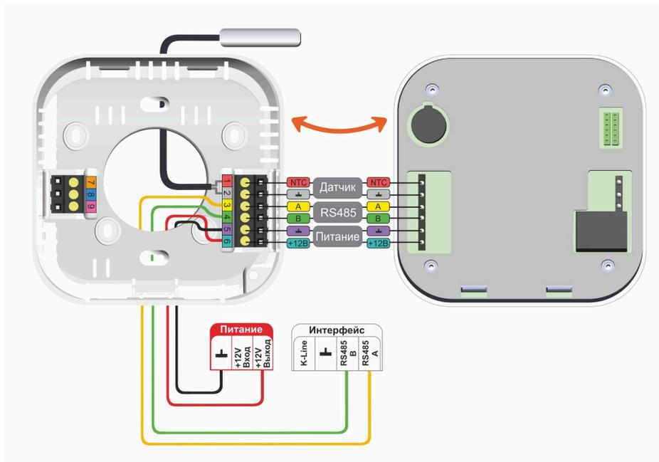
Комнатный термостат ZONT МЛ-232 поддерживает температуру в отдельной зоне обогрева. При подключении к Контроллеру, он определяется сервисом ZONT как новый цифровой датчик температуры и отображает данные о температуре в месте своей установки. Если к термостату подключен дополнительный датчик пола, то его показания тоже отображаются в сервисе. Дайте каждому датчику индивидуальное название, характеризующее измеряемую им среду.
