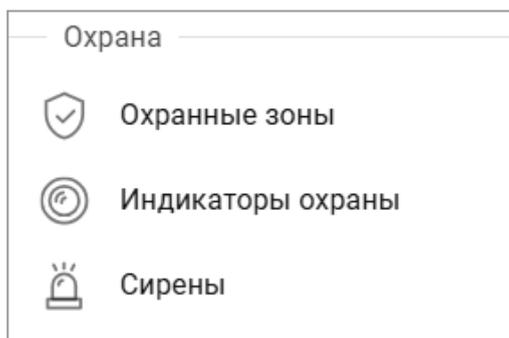
Контроллер можно использовать как устройство охраны. В настроечных параметрах его конфигурации предусмотрено создание охранных зон, а также управление сиренами и оповещателями. Перед подключением сирен и оповещателей выполните настройку блока “Охрана”.
