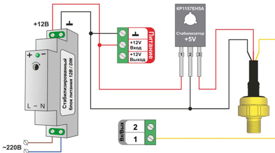
Вместо стабилизатора КР1157ЕН5А можно использовать любой аналогичный в корпусах ТО-126 или ТО-92. Наименование выводов на схеме приведено для стабилизатора КР1157ЕН5А. При использовании аналогов, наименование выводов надо смотреть в документации на стабилизатор.
