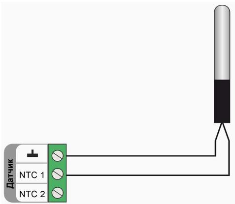
Аналоговые датчики NTC 10к не имеют полярности. Подключение датчиков рекомендуется выполнять экранированным кабелем МКЭШ или кабелем УТР (витая пара). При этом экран кабеля и все неиспользуемые проводники витой пары должны быть подключены к минусу питания Контроллера, а со стороны датчика никуда.
