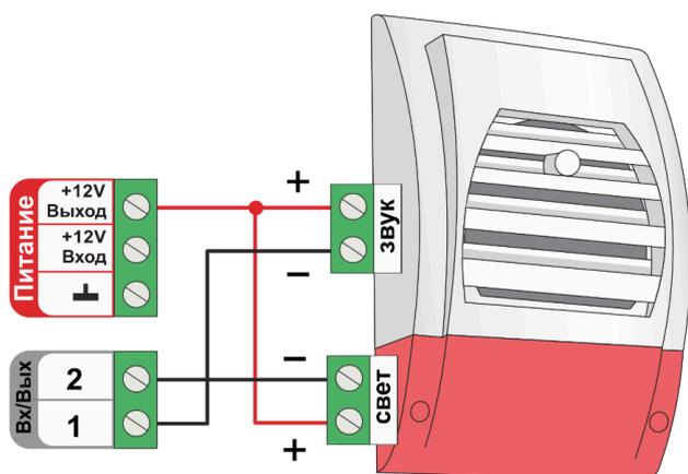
подключение к встроенному реле:
