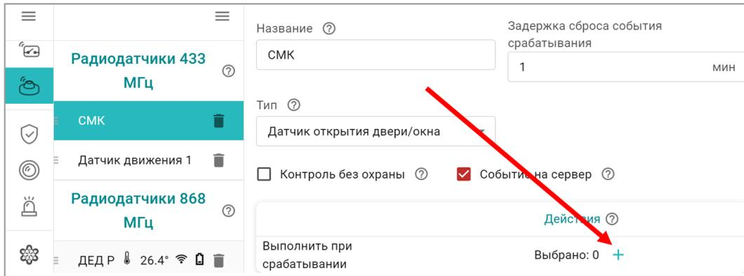
**ВНИМАНИЕ!!!** Датчики 433 МГц посылают сигнал тревоги только при срабатывании, фактическое состояние датчика при этом не отслеживается. Например, датчик открытия двери отправит сигнал тревоги при самом факте открытия. Если дверь останется открытой, повторных сигналов не будет — следующий сигнал придёт только после того, как дверь сначала закроется, а затем снова откроется.
