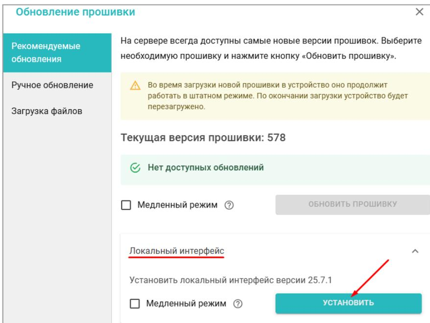
Откройте раздел настроек прибора *Настройки - Сервис - Конфигурация* и установите актуальную версию прошивки прибора. Затем установите версию локального интерфейса:
