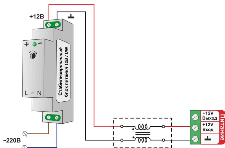
При особенно сильных помехах, например на объектах где используются частотные регуляторы мощности / оборотов и насосы, используйте синфазный фильтр подавления электромагнитных помех номиналом не менее 500 мкГн с допустимым током не менее чем ток потребления всех подключенных к блоку питания устройств. Фильтр должен быть включен в разрыв цепи питания Контроллера (между блоком питания и Контроллером).
