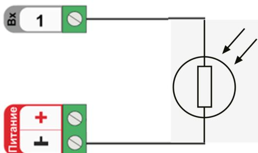
В качестве примера схемы подключения резистивного датчика приведена схема для подключения фоторезистора MLG5506.
