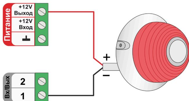
подключение к встроенному реле:
