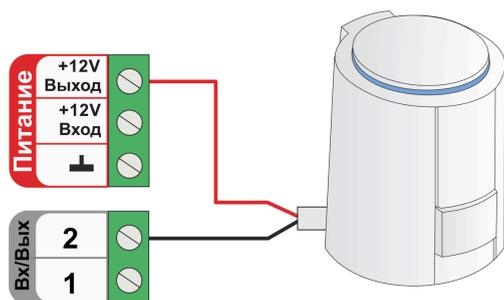
Электропривод двухходового смесительного клапана с **напряжением питания +12 В** подключайте или к выходу ОК или к релейному выходу Контроллера. При этом учитывайте, что ток потребления электропривода не должен превышать 100 мА.
