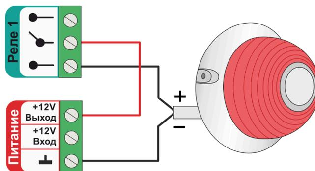
Схема подключения **светозвукового оповещателя** с напряжением питания +12В:
