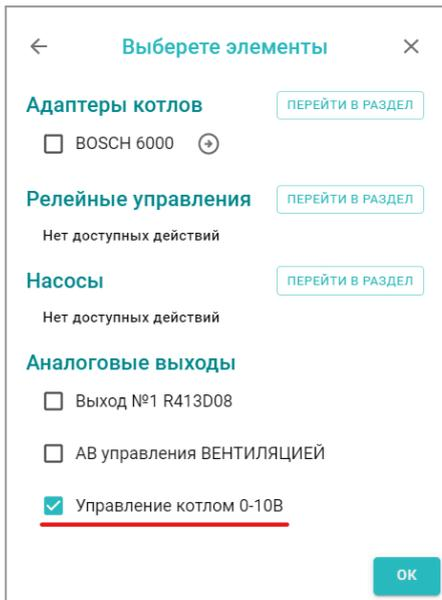
Для настройки управления в конфигурации Контроллера котловому контуру надо указать “исполнительное устройство” – Аналоговый выход 0-10В. Напряжение, формируемое на этом выходе будет являться внешним сигналом управления для котла.
