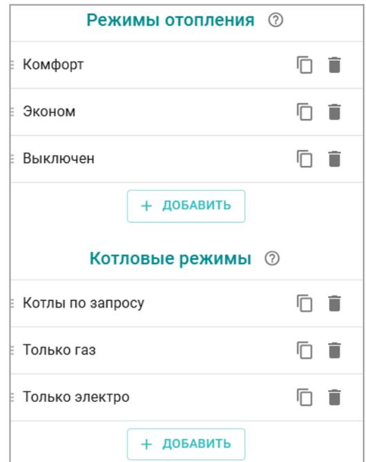
*Котловой режим определяет* каждому котлу (в случае с каскадом – каскаду и котлу) способ управления (работы):
