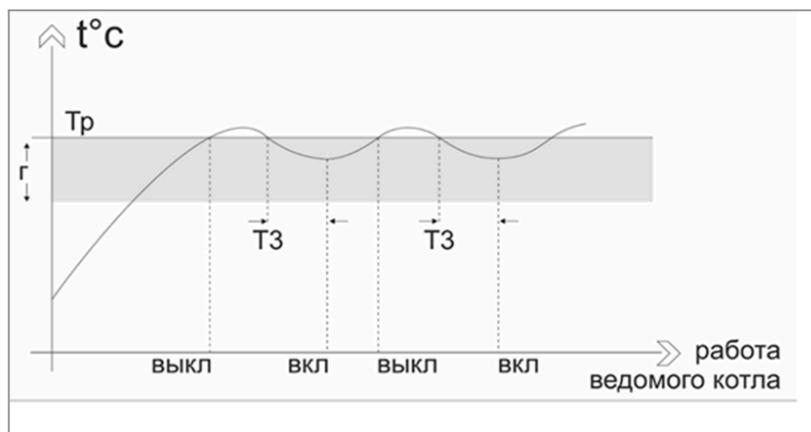
Отличие релейного каскада от модулирующего каскада заключается в том, что при релейном управлении невозможно включить котел в нагрев теплоносителя на температуру, отличающуюся от его сервисной настройки, т.е. расчетная температура (уставка), вычисленная алгоритмом не меняет ее. Котлы в релейном каскаде всегда включаются на свой максимум.
