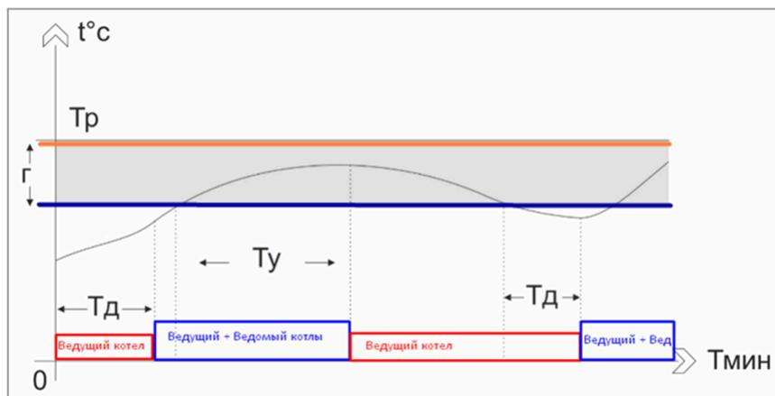
По запросу на тепло от любого из отопительных контуров, стартует ведущий котел и одновременно с этим начинается отсчет **Тд** времени задержки на включение ведомого котла.
