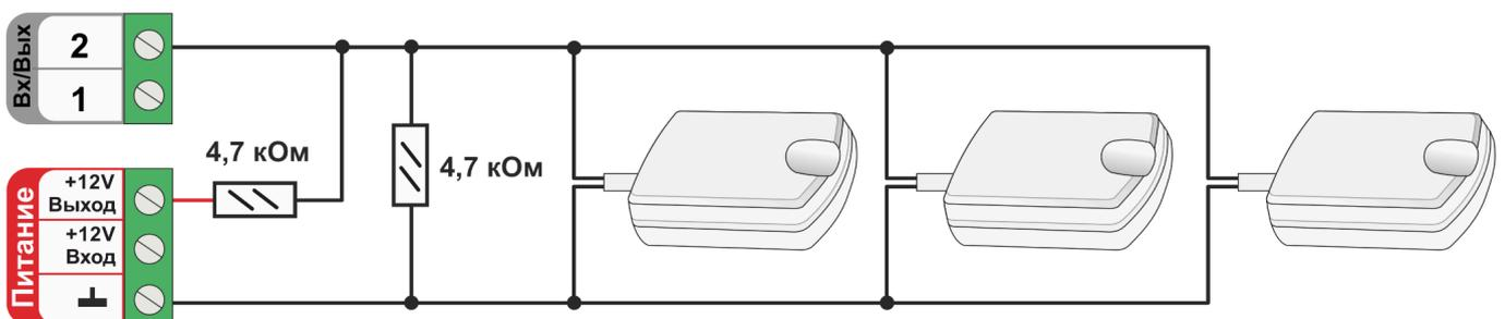
**Примечание:** Обратите внимание, что при ошибке полярности подключения датчика Астра 361 на входе, к которому он подключен всегда отображается его сработка.
