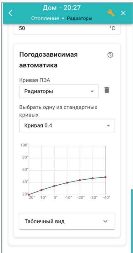
Каждому отопительному контуру Контроллера можно задать индивидуальную кривую ПЗА. Их можно или выбрать из предлагаемого списка сохраненных в заводской конфигурации типовых кривых по номеру (см. рисунок из п. 10), или построить самостоятельно с помощью графика или заполнения таблицы.
