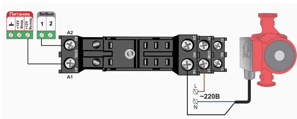
**Примечание:** К универсальным выходам (OK) насосы подключаются через дополнительное промежуточное реле с управляющей обмоткой +12В. При подборе реле учитывайте, что номинальные напряжение и ток должны соответствовать подключаемой нагрузке.
