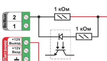
Особенность этой схемы заключается в том, что опореле может включиться (загорится внутренний светодиод оптрана) даже от малого тока через цепь +3,3 В - 100 КОм - оптрон - +12 В. Чтобы этого не произошло, рекомендуем включить дополнительные резисторы номиналом 1 КОм.
