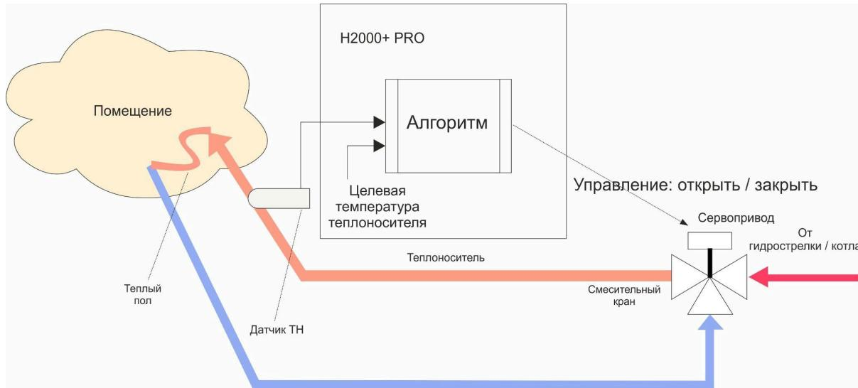
**“Управление по воздуху”** – Контроллер анализирует разницу между Целевой и фактической температурой воздуха в помещении и посыпает импульсы управления сервоприводу для движения в нужном направлении.
