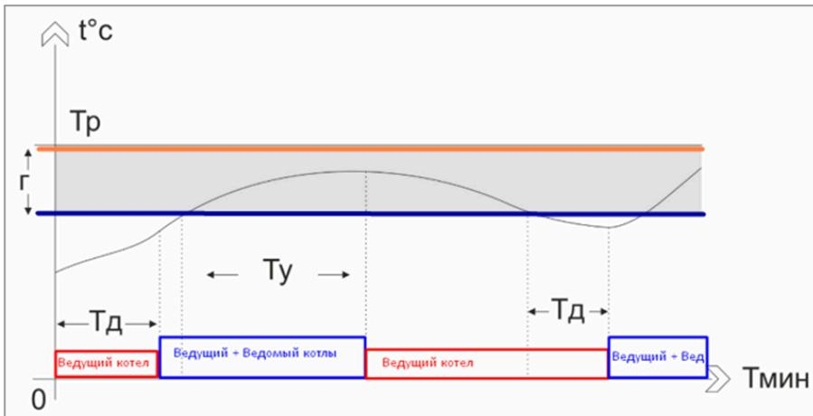
По запросу на тепло от любого из отопительных контуров, стартует ведущий котел и одновременно с этим начинается отсчет  $T_d$  времени задержки на включение ведомого котла. Если за это время температура в гидрострелке успевает достичнуть зоны гистерезиса – ведомый котел не запускается и продолжает работать только ведущий. Если же не успевает, то ему в помощь запускается ведомый котел.
