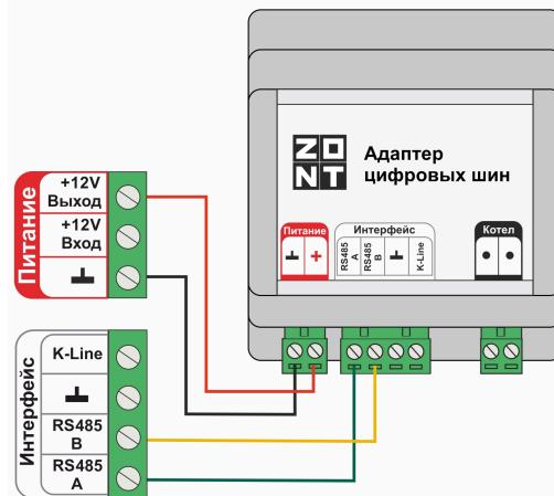
**Примечание:** Полярность подключения к цифровойшине котла значения не имеет.
