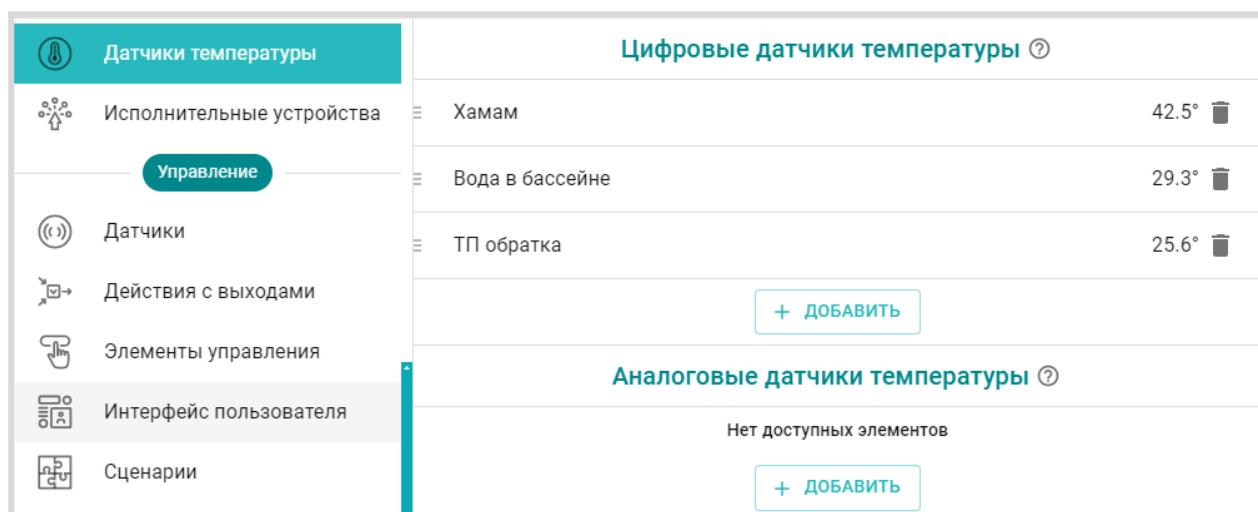
**ВНИМАНИЕ!!!** При подключении к Контроллеру аналоговый датчик температуры автоматически не определяется и не отображается в конфигурации Контроллера. Его необходимо добавить вручную в разделе настроек “Аналоговые датчики температуры”, указать номер Входа (NTC или универсального), к которому датчик физически подключен, тип подключаемого датчика и сопротивление резистора подтяжки, если датчик подключен к универсальному входу/выходу, а не ко входу NTC.
