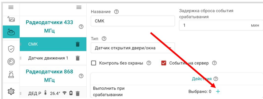
**ВНИМАНИЕ!!!** Необходимо помнить, что стандартные датчики 433 МГц могут отправлять Контроллеру сигнал тревоги только в момент сработки и не отправляют Контроллеру сигналы о дальнейшем своем состоянии. Т.е. если вы используете стандартный датчик открытия двери 433 МГц, то сигнал тревоги датчик отправит после открытия двери. Если дверь не закроется Контроллер не получит повторных сигналов тревоги. Следующий сигнал тревоги датчик отправит только после закрытия двери и следующего открытия двери.
