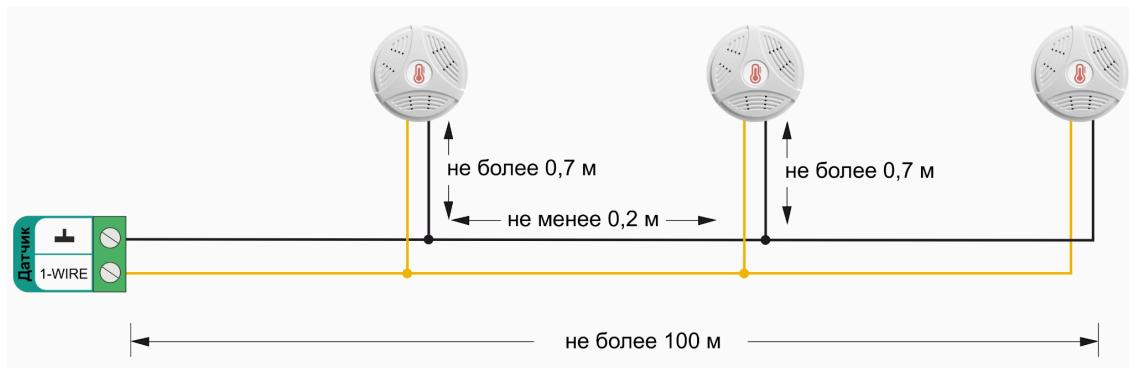
Подключение датчиков по трехпроводной схеме:
