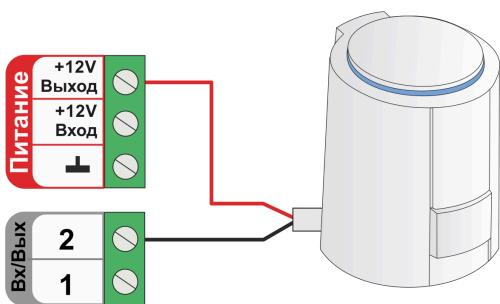
Схема подключения к релейному выходу:
