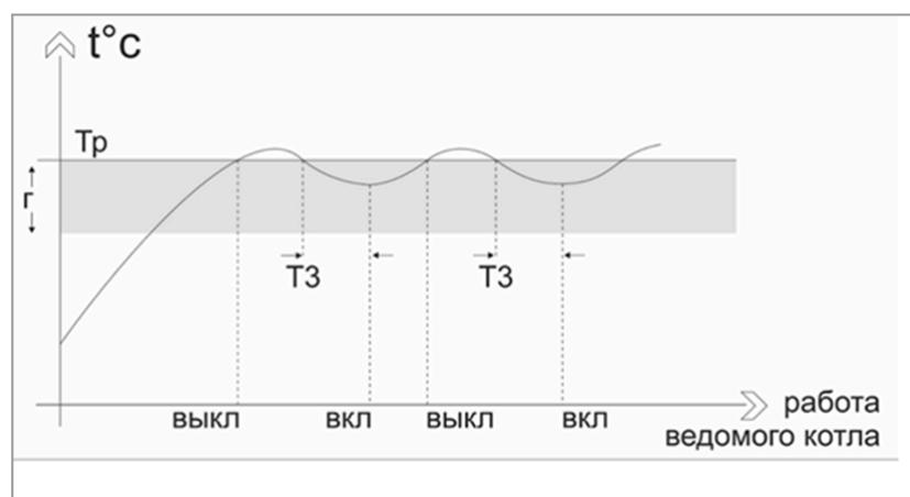
Отличие в работе такого каскада только в том, что при релейном управлении котлами в принципе не существует расчетной температуры (уставки) каждому котлу – они всегда включаются в нагрев на разрешенный сервисной настройкой максимум.
