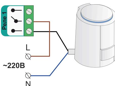
**Электроприводы с напряжением питания +12 Вольт** можно подключать к выходу OK, непосредственно к клеммам Контроллера. Но при этом важно учесть, что ток потребления электропривода не должен превышать 100 мА – значения заявленного в характеристиках выхода OK Контроллера.
