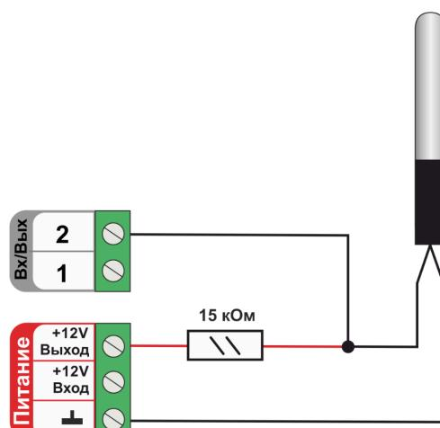
Для подключения датчиков NTC-10 к универсальным входам/выходам необходимо использовать подтягивающий резистор 15 кОм с точностью 1%, подключенный между входом и клеммой питания “+12 В”.
