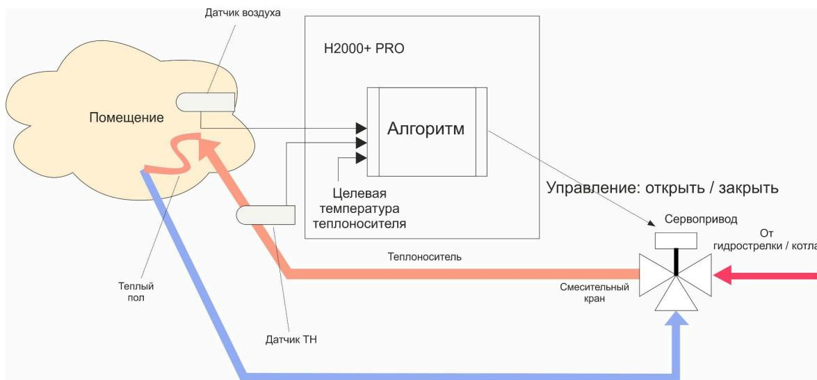
Для такого способа регулирования нужно контролировать два датчика – температуры воздуха в помещении и температуры теплоносителя в контуре за смесительным краном.
