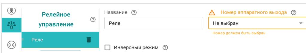
Параметр **Инверсный режим** меняет исходное состояние выхода на противоположное. Таким образом релейный нормально разомкнутый (НР) выход становится нормально замкнутым (НЗ), релейный выход НЗ становится НР, а Выход ОК в активном состоянии имеет +12В, а не 0В.
