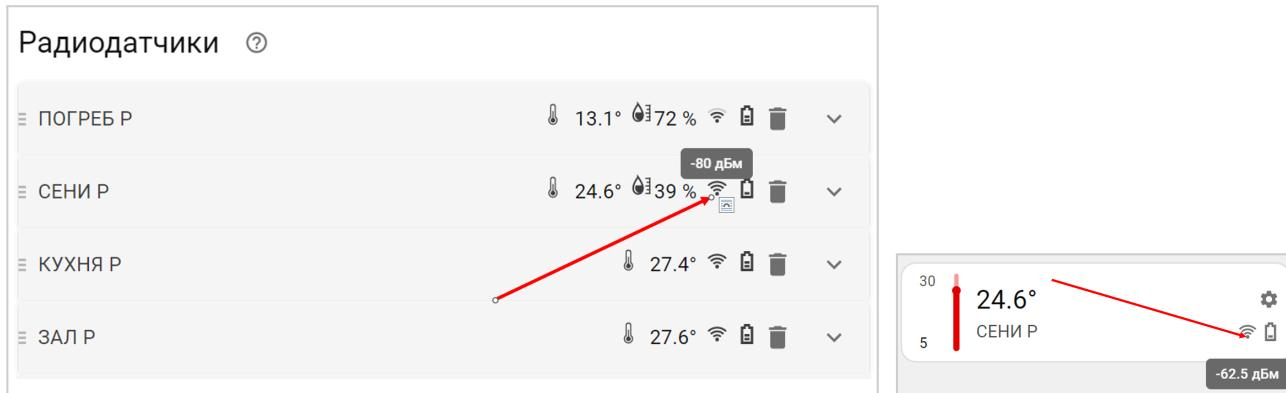
**ВНИМАНИЕ!!!** Если мощность радиосигнала датчика менее -90ДБм, то обмен данными с ним не стабильный, и Контроллер будет периодически информировать о потере связи с радиоустройством. В этом случае необходимо найти другое место для размещения радиодатчика и/или радиомодуля.
