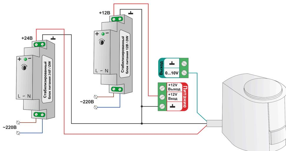
**ВНИМАНИЕ!!!** Некоторые приводы запитываются от источников питания переменного тока. В тех случаях когда привод имеет три вывода – два из которых питание привода и третий управляющий - схема подключения такая же как и для приводов запистананных от источников постоянного напряжения.
