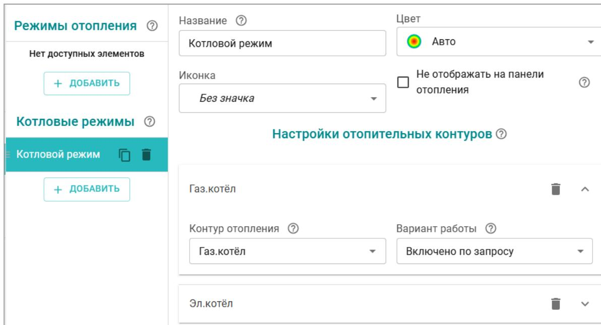
У каждого котла в конфигурации контроллера должен быть задан свой датчик температуры теплоносителя. Для котла управляемого по ЦШ этим датчиком является адаптер цифровой шины через который контроллер подключен к котлу. Для Каскада в котловом режиме назначается датчик температуры теплоносителя установленный на гидрострелке.
