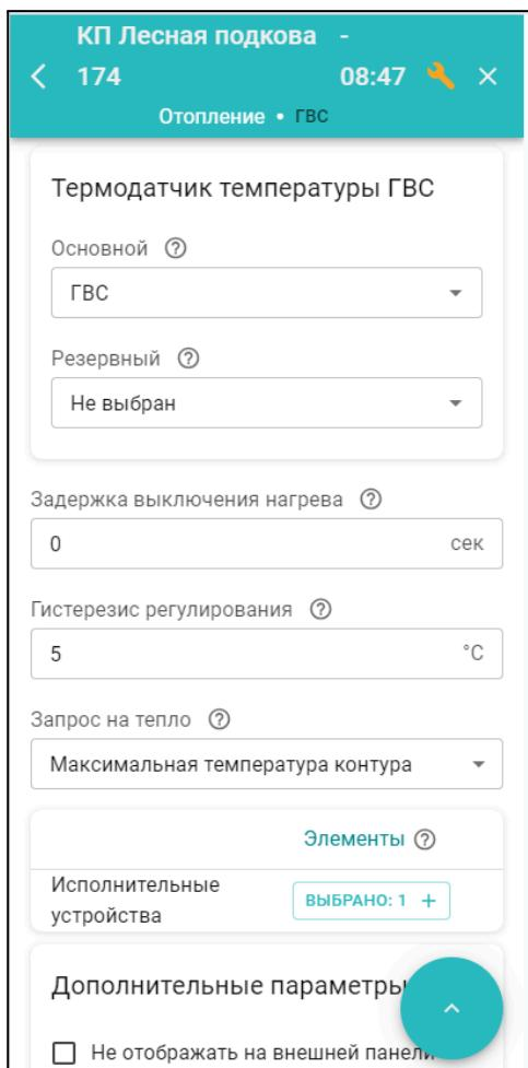
В конфигурации Контроллера задается отдельное исполнительное устройство "насос загрузки бойлера", а на вкладке Отопление задаются параметры работы контура – **"Запрос на тепло"**, **"Датчик температуры ГВС"**, **"Исполнительные устройства"** и **"Гистерезис регулирования"**.
