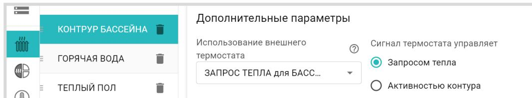
При такой настройке, появление на входе дискретного сигнала, будет формировать “запрос на тепло” котловому контру, т.е. включать котел в нагрев. **Целевая температура** нагрева теплоносителя задается с панели контура на вкладке “Отопление”.
