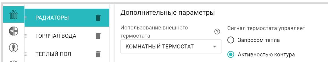
В этом случае при появлении на указанном входе Контроллера сигнала от Комнатного термостата, контур будет не только формировать “запрос на тепло” контуру Котла, но и поддерживать заданную этим термостатом целевую температуру.
