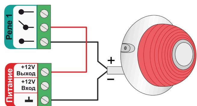
Для подключения **светозвуковых оповещателей** используются два выхода контроллера.
