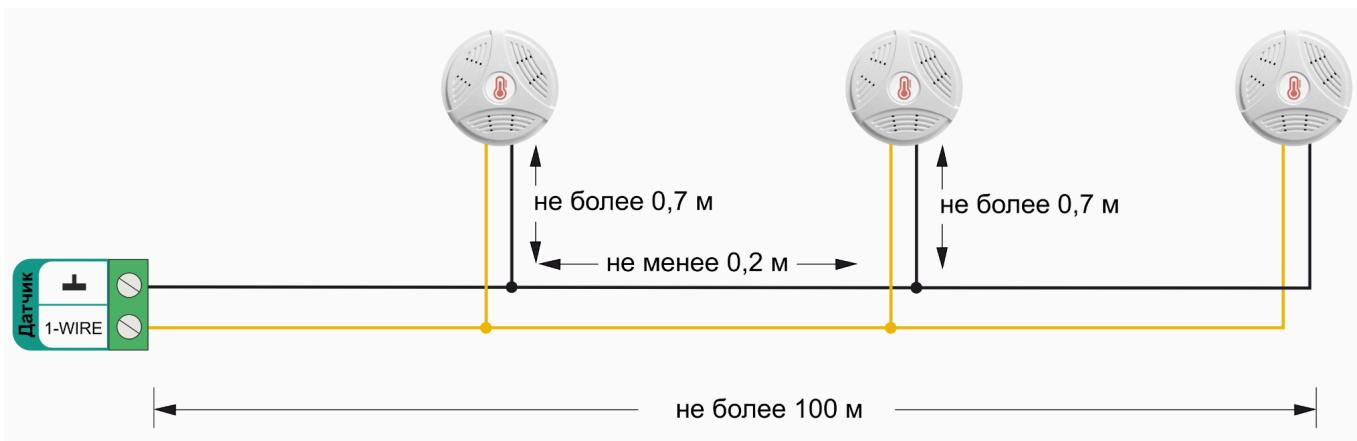
Подключение датчиков по трехпроводной схеме:
