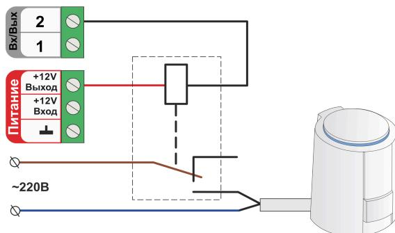
В качестве дополнительного промежуточного реле рекомендуется использовать **реле 12V DC артикул ML00000291**. Ссылка на карточку товара ресурс Zont-online.ru [Реле промежуточное на DIN-рейку, 12V DC в сборе](#).
