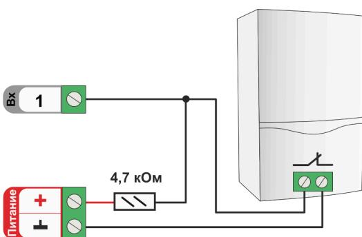
Для сигнала “**Авария котла +**” расчет пороговых значений контролируемого напряжения проводится по формулам:
