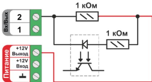
Особенность этой схемы заключается в том, что оптрон может включаться (загорится внутренний светодиод оптрана) даже от малого тока через цепь +3,3 В – 100 кОм – оптрон – +12 В. Чтобы этого не произошло, рекомендуем включить дополнительные резисторы номиналом 1 кОм.
