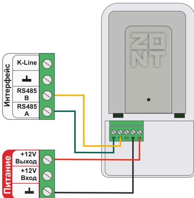
Схема подключения радиомодуля по K-Line:
