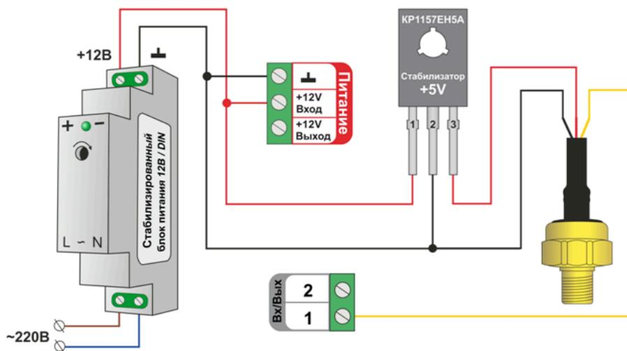
Вместо стабилизатора KP1157EH5A можно использовать любой аналогичный стабилизатор напряжения +5В в корпусах ТО-126 или ТО-92.
