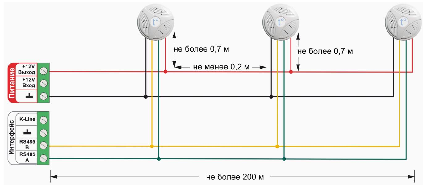
Подключение нескольких датчиков по K-Line:
