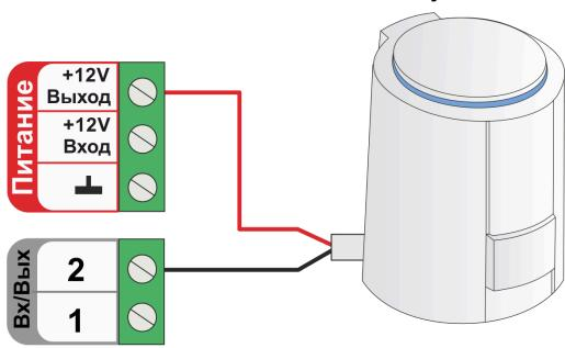
Схема подключения к релейному выходу:
