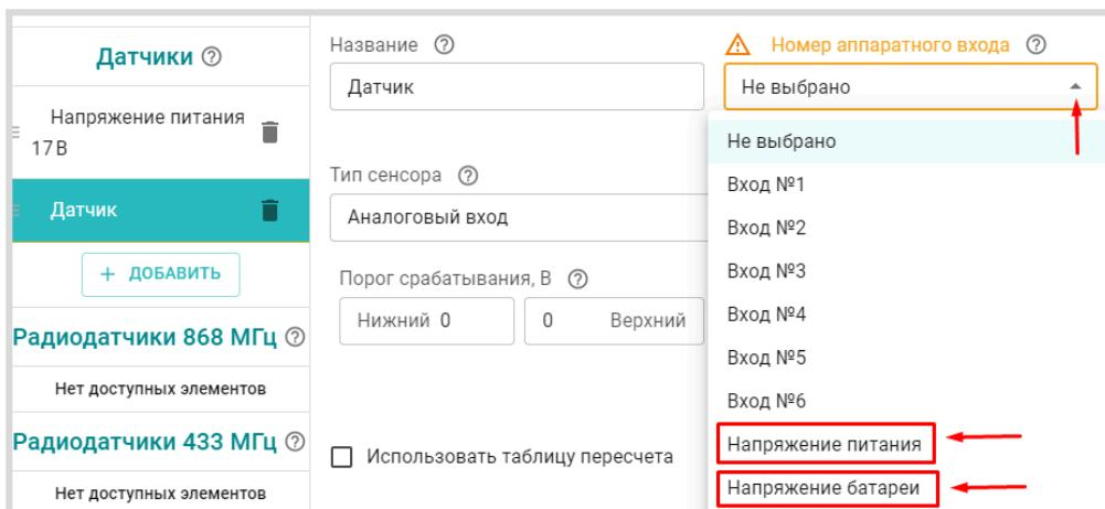
Для формирования оповещений об отклонении и восстановлении напряжения питания, а также выполнения заданных действий по таким событиям, в настройке необходимо указать нижний и верхний пороги срабатывания и включить параметр “Событие на сервер при срабатывании”.
