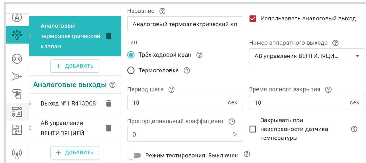
**ВНИМАНИЕ!!!** В случае использования в качестве Исполнительного устройства в отопительном контуре аналогового термоэлектрического клапана (термоголовки) необходимо выбирать **нормально закрытый клапан**. При использовании нормально открытого клапана алгоритм управления работать не будет.
