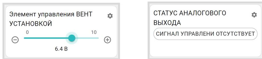
**Примечание:** Статус аналогового выхода будет активен только пока контроллер дает команду приводу на движение. В ручном режиме статус привода будет всегда в пассивном состоянии, т.к. ручная команда мгновенно изменяет состояние выхода с текущего на то, которое выставлено вручную.
