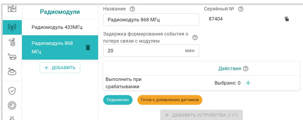
**Для регистрации датчиков 868 МГц** в период действия режима добавления радиоустройств нужно нажать и удерживать кнопку на плате датчика до того момента пока светодиодный индикатор на нем не загорится на 1-1,5 секунды.
