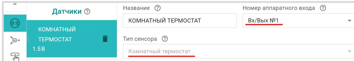
В настройке такого контура указать, что сигнал термостата управляет **Активностью контура**
