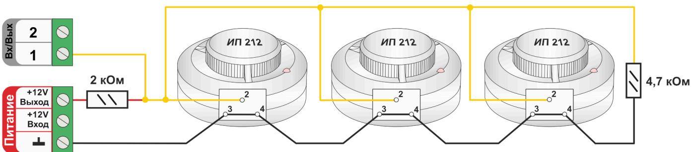
Для правильной работы датчиков требуется установка дополнительных резисторов:
